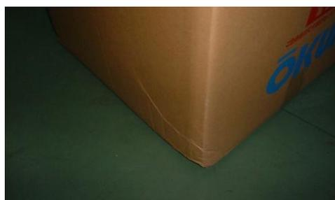
落下の仕方によっては左写真のように外装箱の大きな損傷もなく発見が困難な状態にあります。破損に結びつく落下高さはポケット形状や材料の板厚により異なりますので一概には明確に出来ません。
